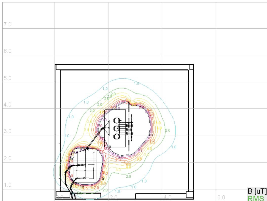
Figura 4.10 - Linhas de campo B em plano  $z=1,0m$  utilizando o modelo Back to Back com um painel de alumínio com retícula de **4 cm** e secção de **16 mm<sup>2</sup>**
