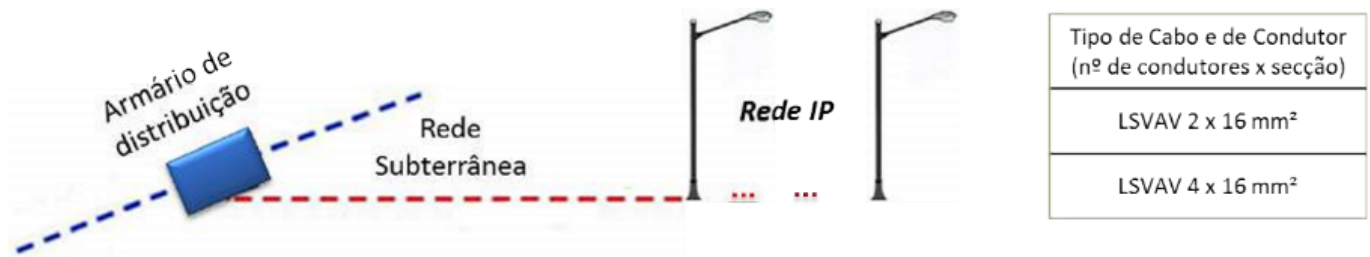
Figura 8.7 - Ligação através de linha subterrânea da rede de iluminação pública.
