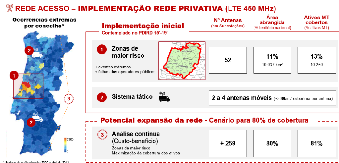
Figura 7.3: Rede de Acesso - Fase I: Implementação da rede privativa (LTE 450MHz)
