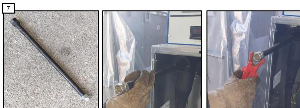
Figura 10 – Dispositivo auxiliar para ligação da ponta de prova
