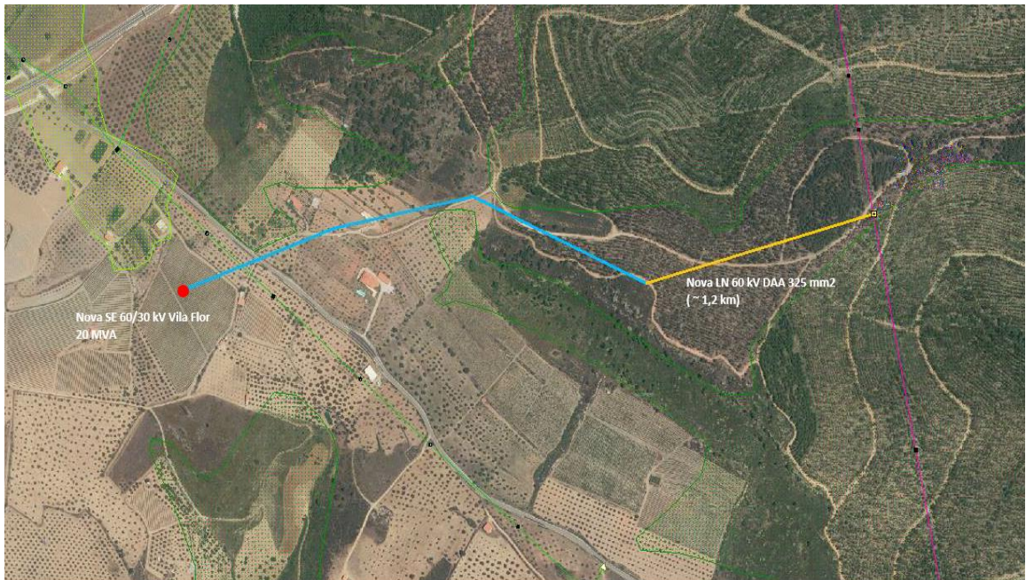
Figura 2: Zonas de intervenção previstas no projecto Nova SE 60/30 kV em Vila Flor
