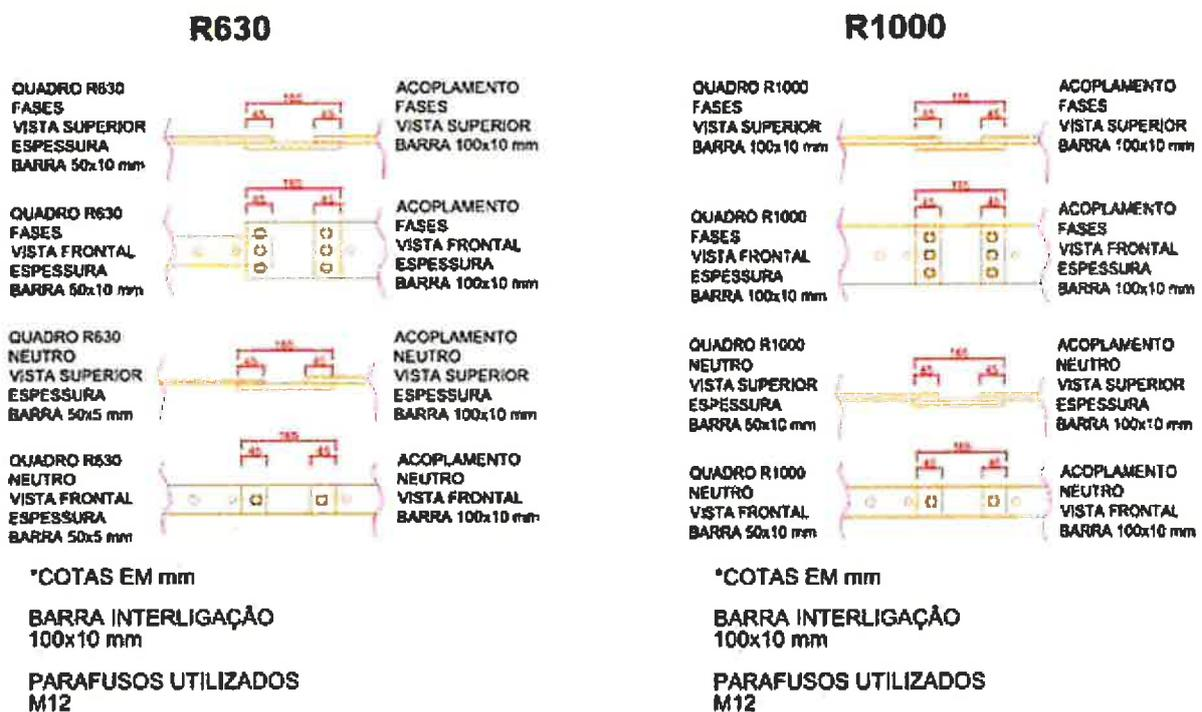
Fig.10A – Prolongamento dos barramentos para ligação dos acoplamentos dos módulos de extensão
